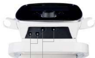
Σύνδεσμοι εφαρμοστή υπερήχων (Ultrasonic applicator connectors) Σύνδεσμοι καλωδίων μοττύβδου για ηλεκτροδιέγερση (Mobile phone cable connectors for electrostimulation)
