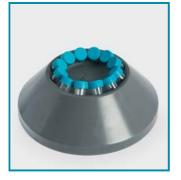
Высокопрочный пластиковый ротор и превосходная технология балансировки гарантируют бесшумную и стабильную работу.
