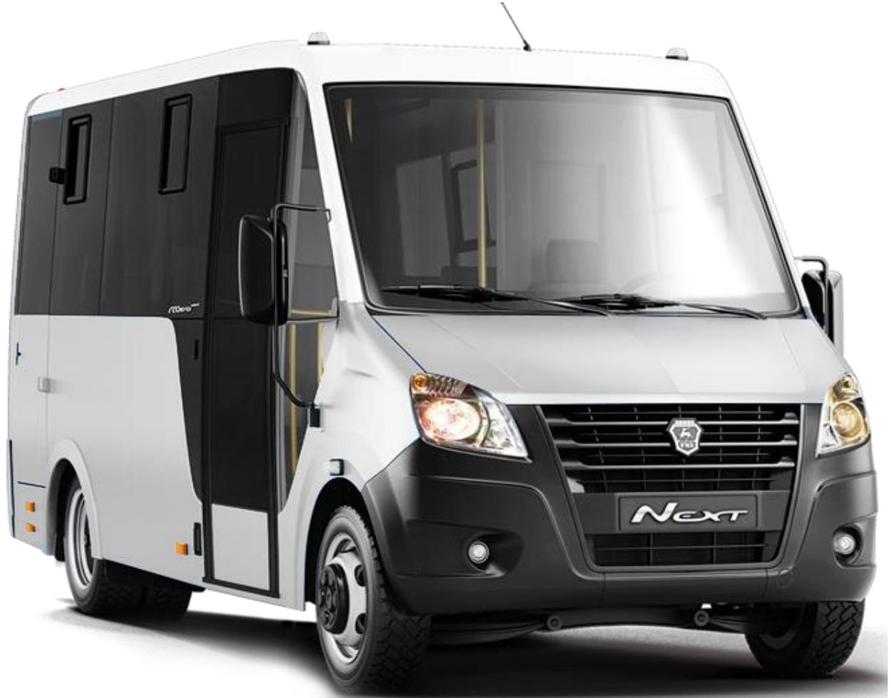
ГАЗ А64R42 – это просторный 19-местный автобус для внутригородских и пригородных маршрутов. Характеризуется высокими эксплуатационными качествами, надежностью и минимальными трудозатратами при обслуживании и эксплуатации. Автобус создан на базе модифицированных узлов автомобиля ГАЗель NEXT (максимально допустимая масса 4300 кг): усилены задние рессоры, изменены передаточные числа усиленной КПП, установлены передний и задний стабилизаторы поперечной устойчивости.
