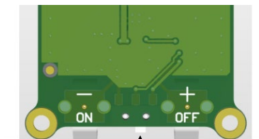
Fig. 19: Interruttore batterie del Wöhler M 602 (freccia)
