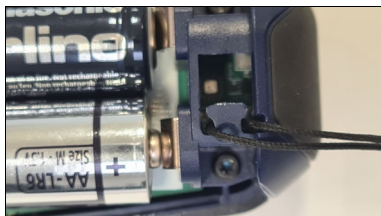
Abb. 2: Befestigung der Handschlaufe unterhalb des Batteriefachs
