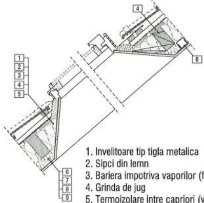
Detaliu îmbinare fereastră de mansarda
