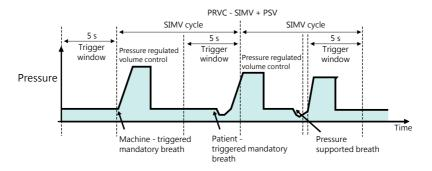
Figure 6-11.V+SIMV waveform
