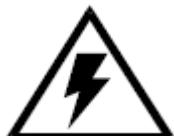
Символ молнии внутри треугольника предупреждает о наличии «опасного напряжения» без изоляции внутренних частей оборудования; напряжение может быть достаточно сильным, чтобы создавать риск удара током.
