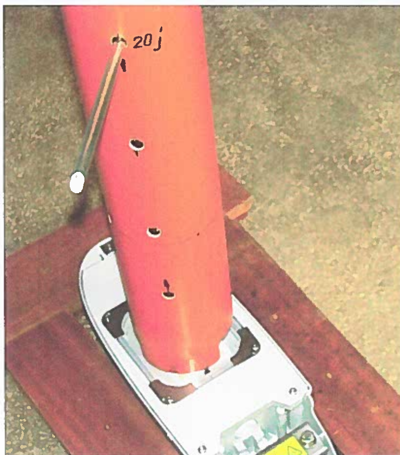
Fig. 2 – Corpul de iluminat VOLTANA 0-8LED pregătit pentru verificarea la impact (IK 10)
