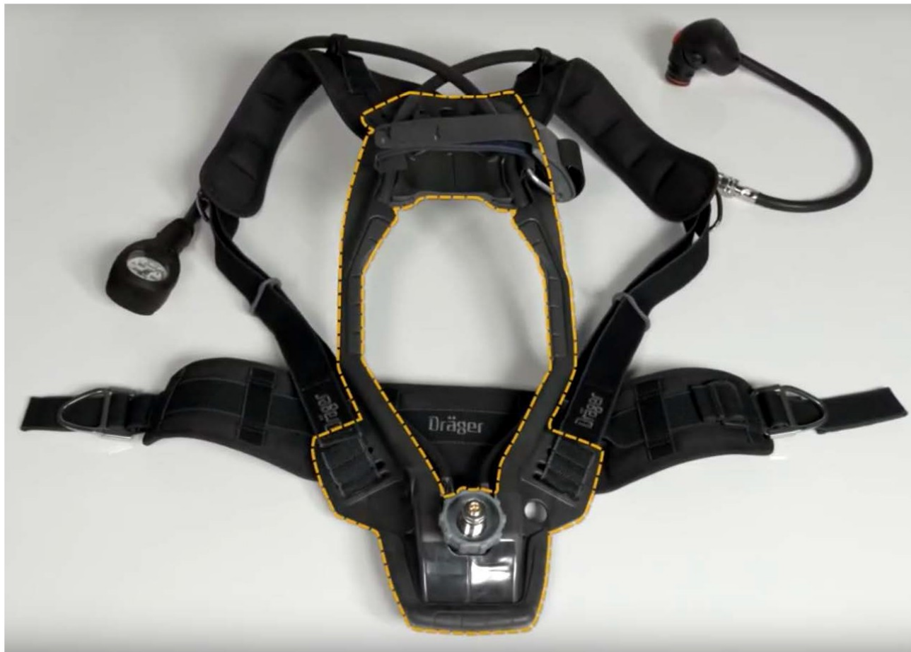
Fig. 5. Cadrul aparatului de respirație văzut din spate (cadrul evidențiat cu linie întreruptă). Părțile laterale ale cadrului au margini rotunjite, formând mânere, reductorul de presiune și conductele de presiune ridicată și joasă sunt ascunse în caneluri. Pozițiile conductelor (stânga-dreapta) pot fi schimbate între ele.
