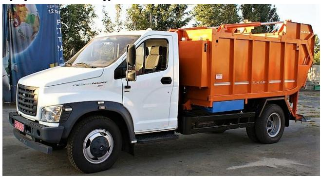
Мусоровоз Місто, **с** возможностью перегруза мусора в крупнотоннажные мусоровозы, (лицензия Zoeller, Германия) идеально подходит для использования в сложных условиях плотной застройки, в пешеходных и парковых зонах. Предназначен для механизированной загрузки твердых бытовых отходов из контейнеров объемом 60 – 1100 л (EN840/1, EN840/3) в бункер, их уплотнения и транспортировки к местам утилизации, также есть возможность загружать отходы в мешках, из уличных урн и не упакованный мусор.
