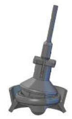
Figura 15a: Suport de susținere/rotație a valvei fixat impropriu.
