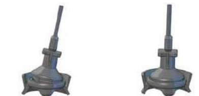
Figura 15a. Suport de susținere/rotație a valvei fixat incorect.
