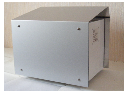
Рисунок 4 – Внешний вид корпуса, закрывающего трансформатор пробного напряжения.
