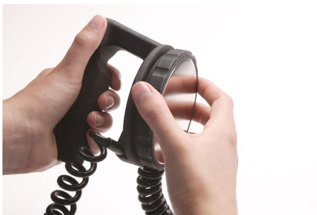
Fig. 15: Fixarea padelor pentru adulți pe electrozii pentru copii
