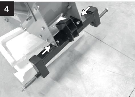
**CS** Přizvedněte tělo stroje na straně plnicího kanálu a namontujte čtyřmi šrouby M8 osu přepravních kol. Pozor na možnost otočení. Osa se montuje tak aby šikmé uchycení oje bylo výšší stranou směrem dopředu (od stroje).
