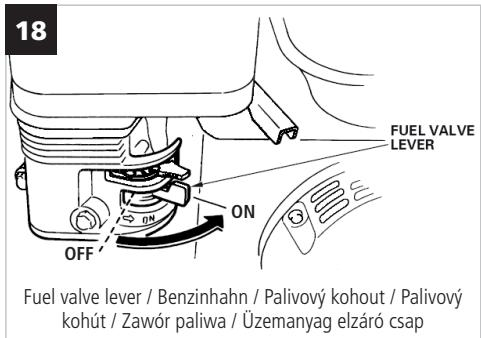
Fuel valve lever / Benzinhanh / Palivový kohout / Palivový kohút / Zawór paliwa / Üzemanyag elzáró csap
