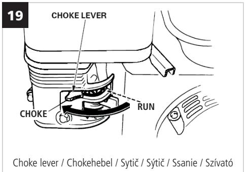
Choke lever / Chokehebel / Sytič / Sýtič / Ssanie / Szívató
