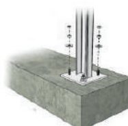
Установка на бетонные блоки
