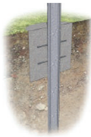
Забивка с бетонирование
