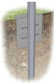
Забивка с бетонированием
