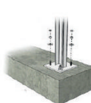
Установка на бетонные блоки
