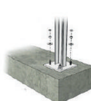
Установка на бетонные блоки
