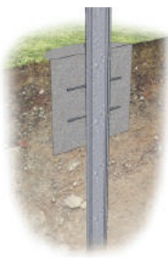
Забивка с бетонированием
