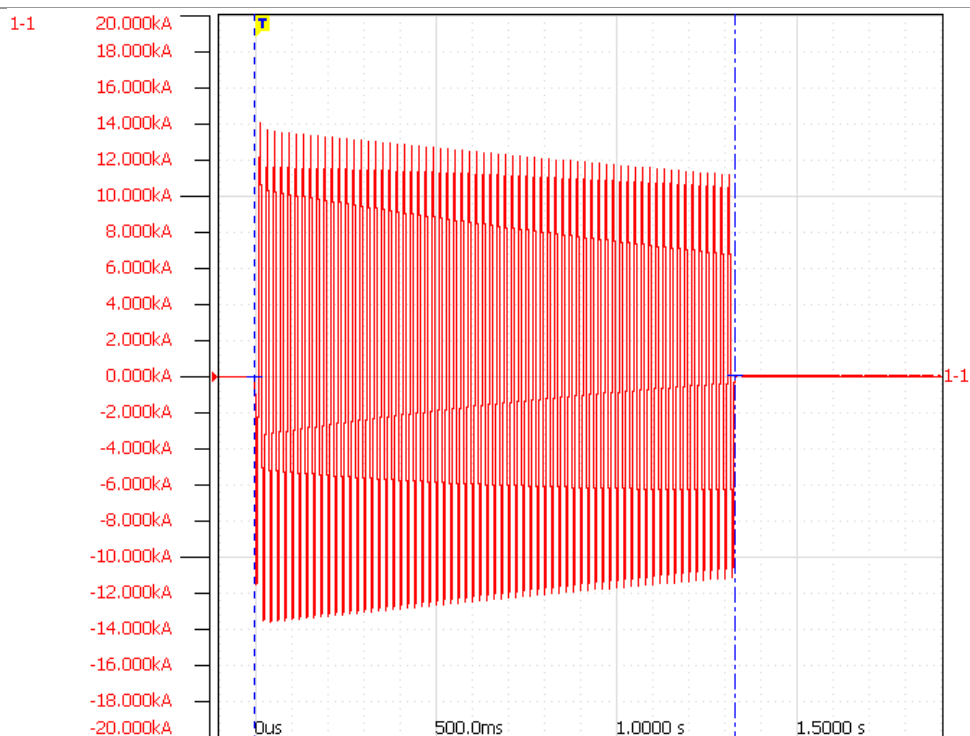
Oscylogram 1. Przebieg prądów podczas próby wytrzymałości zwarcia żyły powrotnej. Próba nr 5579/2019.05.08
