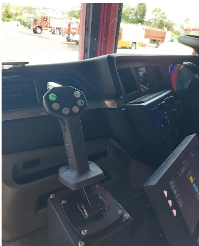
Joystick pentru operarea tunului de apă/spumă
