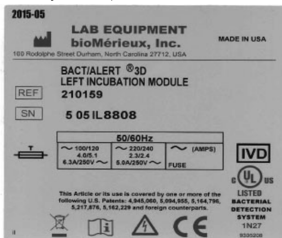
Figura 2-4: Eticheta Echipamentului de laborator - Modulul de incubare stânga (Utilizare în domeniul medical și industrial)
