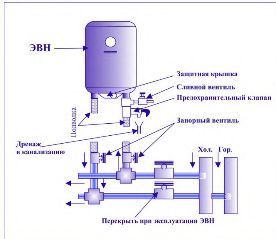
Рис. 1. Схема подключения ЭВН к водопроводу
