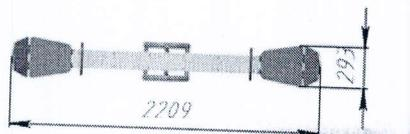
Componente: construcția este constituită din suportul de legănare cu elemente de amortizare din cauciuc, scaune și manere, baza metalică.
