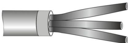
**4.** Удалить защитный пояс оболочки кабеля и снять заусенцы с торца оболочки. Ступень поясной изоляции обезжирить салфеткой, смоченной в бензине или ацетоне.
