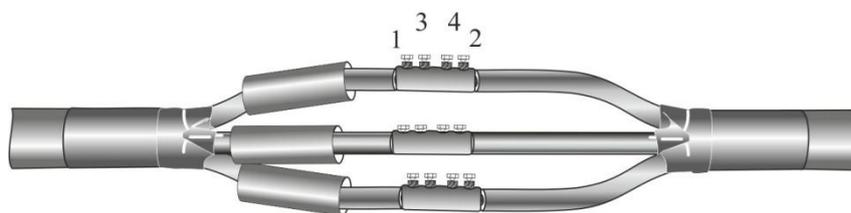
**8.** Сдвинуть на места соединений термоусаживаемые трубки-манжеты №3 и усадить их, начиная от середины. После усадки должен быть заметен выступивший расплавленный клей.
