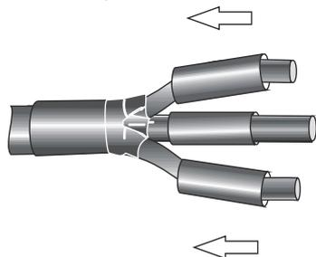
**6.** Надеть на жилы кабеля (с большей стороны разделки) трубки-манжеты №3 для изолирования контактного соединения, продвинув их до корешка разделки (до перчатки).
