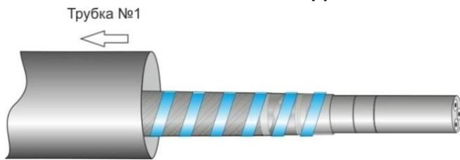
**3.** Снять оболочку кабеля от конца до второго кольцевого надреза. Удалить поясную изоляцию и кордели, жилы кабеля развести. Термоусаживаемые трубки № 2 для изоляции жил одеть на жилы кабелей так, чтобы торец трубки доходил до ступени поясной изоляции кабеля и усадить, начиная от корешка разделки, равномерным прогревом пламени газовой горелки. Пламя горелки должно быть размытым, желтоватого цвета. После усадки трубки должны плотно облегать жилы кабеля, не иметь морщин и складок.
