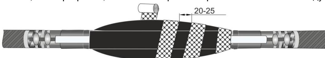
11. Обернуть узлы заземления лентой для герметизации и закрепить их на оболочке и броне кабелей сеткой.
