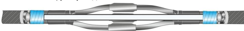
10. Разложить между жилами кабелей пластины заполнителя. Максимально сжать жилы и по поверхности заполнителя выполнить стягивающую подмотку сеткой для банджа заполнителя с натягом, без перекрытий, начиная от корешка перчатки. Расстояние между витками 20-25мм.
