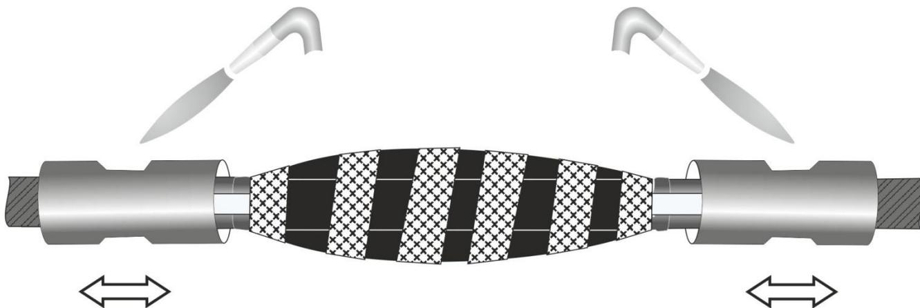
12. Надвинуть на муфту наружную трубку №1 для герметизации муфты, расположив ее симметрично относительно центра муфты. Удалить пленку рукавную. Усадить трубу пламенем газовой горелки, начиная от середины. После усадки по торцам трубы должен быть заметен выступивший расплавленный клей.
