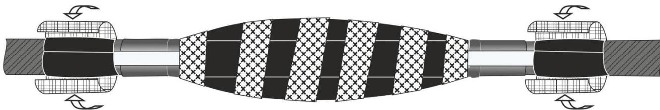
11.1. Для кабеля сечением жил 10-16мм<sup>2</sup> с заходом на оболочку кабеля усадить дополнительные трубки-манжеты №4.
