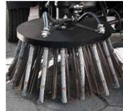
Специальная щетка для удаления растений на краю дороги.
