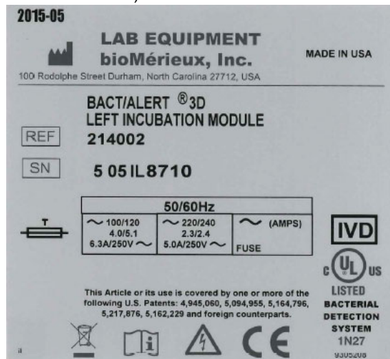
Figura 2-9: Eticheta Echipamentului de laborator - Modulul de incubare MB stânga (Utilizare în domeniul medical)
