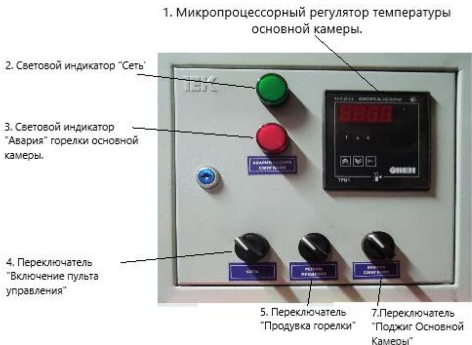
Рисунок 4.1 – Панель управления инсинератором (Тип1) одnogорелочный.
