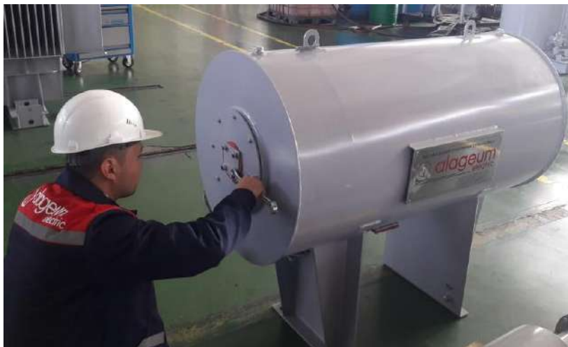
Рисунок 4.8 Снятие заглушки расширителя для установки маслоуказатели
