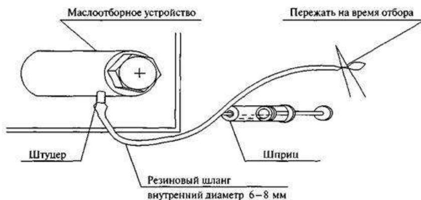
Рисунок . Схема маслоотборного устройства
