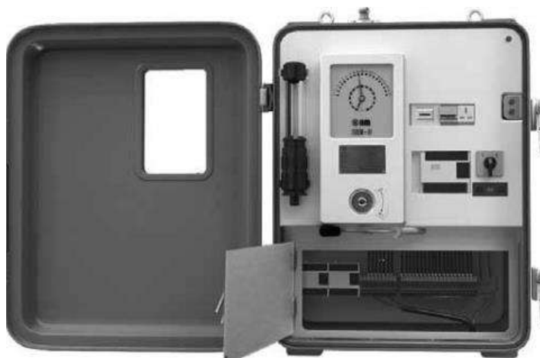
Рисунок 2.4.5 - Моторный привод РПН Хуаминг
