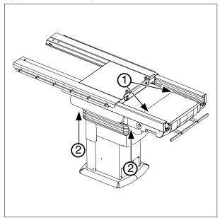
Fig. 76: Table, lubrication
