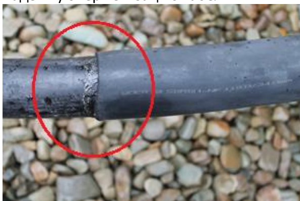
Рис.19 Выделение клея в процессе нагрева термоусадочной трубки
