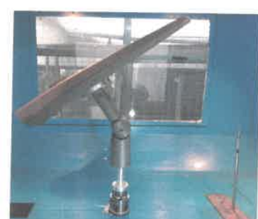
Fig. 22 – Corpul de iluminat montat în camera de experimentare a tunelului aerodinamic în poziția de încercare longitudinal ( \alpha_{xz} = 30^\circ ; \beta_{xy} = 0^\circ )
