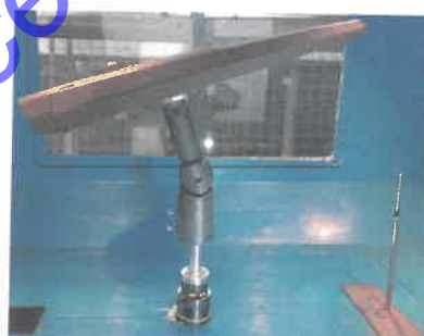
Fig. 21 – Corpul de iluminat montat în camera de experimentare a tunelului aerodinamic în poziția de încercare longitudinal ( \alpha_{xz} = 15^\circ ; \beta_{xy} = 0^\circ )
