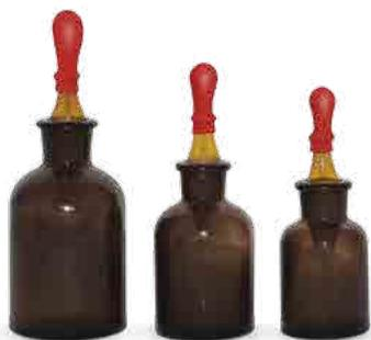
Применяются для отмеривания по каплям различных жидкостей в лабораторной и медицинской практике. Изготовлены из химико-лабораторного стекла янтарного цвета, которое защищает фоточувствительные реактивы от воздействия света.
