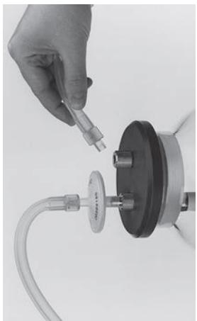
Sauganschluss ⑯ der Saugflasche über den Silikon-Saugschlauch mit dem Sauganschluss des Instruments verbinden.
