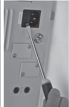
Sicherungshalter mit einem Schraubendreher oder anderem geeigneten Werkzeug lösen.
