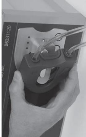
Mediante una animación, se explica el procedimiento de colocación del cartucho para tubos flexibles. Si se cumplen todos los requisitos, es decir, se monta un cartucho para tubos flexibles de codificación válida (HYS o LAP) y se cierra la palanca de la bomba, se produce el acceso al correspondiente nivel de trabajo (histeroscopia o laparoscopía).
