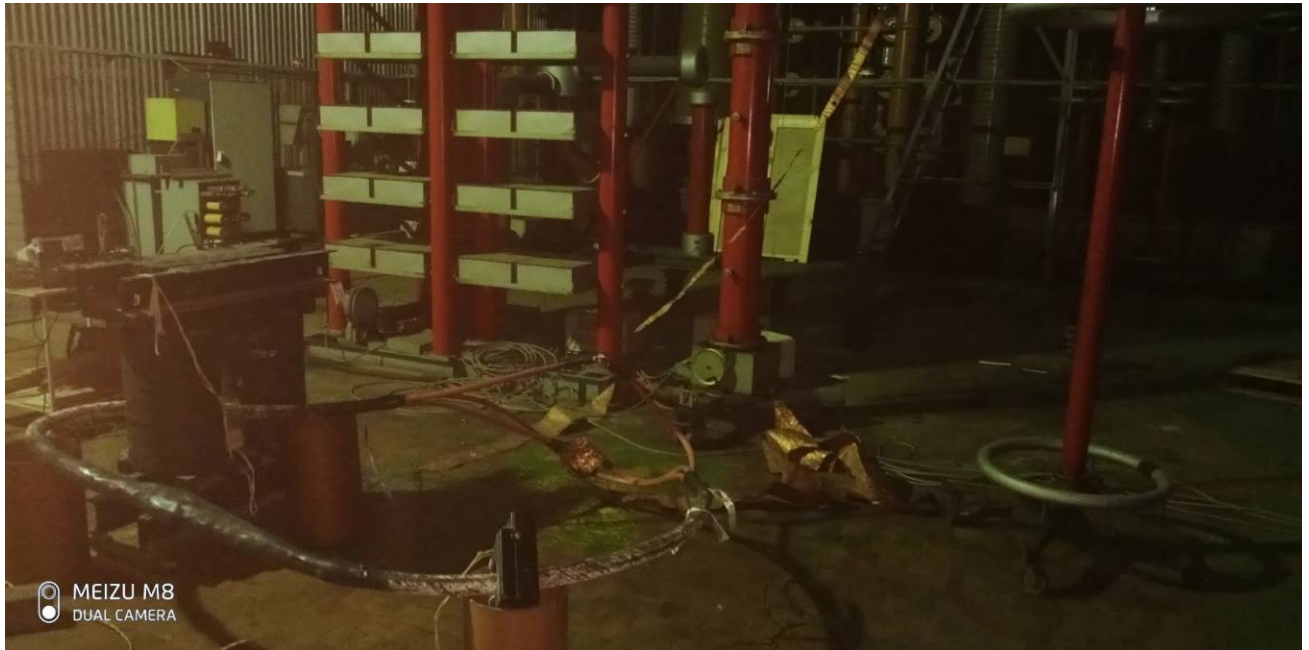
Рисунок 8.4 – Випробування імпульсами напруги (ПГІ), попередньо нагрітого кабелю
