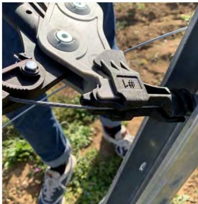
Adaptor – in cazul in care intinzatorul este instalat in interiorul spalierului
