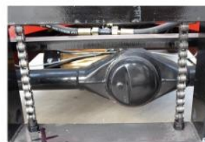
Специальная трансмиссионная ось для электропогрузчика
