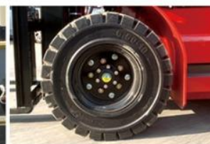
Цельнолитые шины износостойкие
