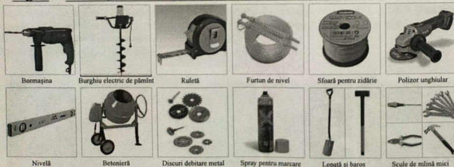
Fig. 1 Scule și unelte necesare pentru lucrările de instalare :
