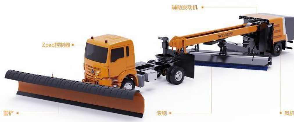
Рисунок 1-1 Общая схема снегоуборочной машины T300 3-в-1
