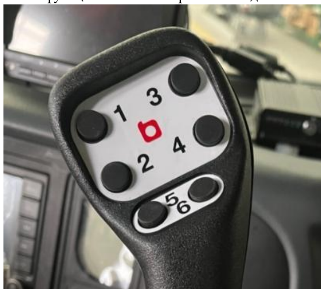
Рисунок 2-3 Многофункциональный направленный джойстик
