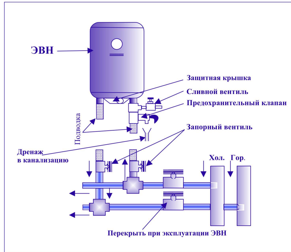
Рис. 1. Схема подключения ЭВН к водопроводу
