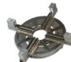
Dispozitiv de sudură capete de flanșă
