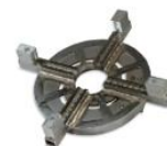
Dispozitiv de sudură capete de flanșă
