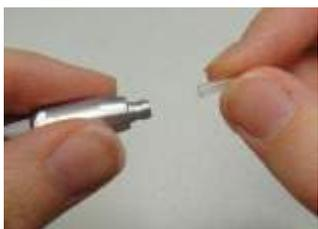
Возьмите новую трубку зонда из упаковки и вставьте ее в головку зонда до полной посадки. Правильно установленная трубка зонда надежно зафиксировается на месте. Трубка зонда также может быть вставлена с помощью инструмента для удаления трубки зонда.
