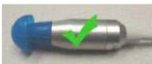
После выбора нужного ушного вкладыша наденьте его до упора на трубку зонда. При этом рекомендуется слегка вращать вкладыш.
