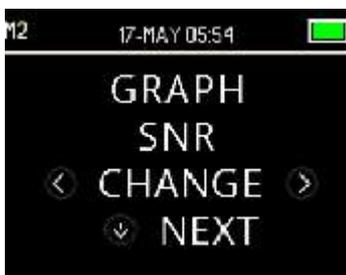
Меню Graph Style (стиль графика) позволяет пользователю выбрать один из двух вариантов отображения результатов. Вариант SNR позволяет видеть соотношение сигнал-шум для каждой тестовой частоты DP или тестовой полосы TE. В варианте Value (значение) на графике отображаются абсолютные уровни эмиссии и шума для каждой тестовой частоты DP или тестовой полосы TE.
