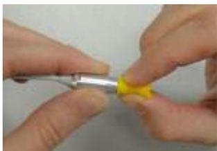
Чтобы заменить трубку зонда захватите ее вместе с ушным вкладышем и вытяните трубку из корпуса зонда. Немедленно утилизируйте использованную трубку, чтобы не перепутать использованные трубки с новыми.
