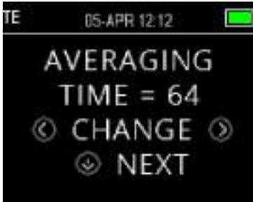
Время усреднения для протокола TE – это максимальное время обследования. Время усреднения имеет огромное влияние на достигнутое соотношение сигнал/шум (SNR) и окончательный результат обследования (например, PASS / REFER). Время усреднения не зависит от процесса проверки зонда.
