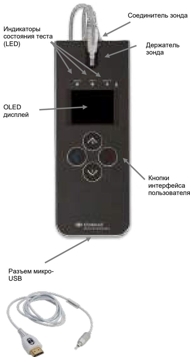
OtoRead™ состоит из прибора, микро-зонда (Micro-Probe), набора одноразовых ушных вкладышей, сменных трубок зонда и других принадлежностей.
