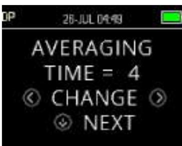
Время усреднения - это время тестирования частоты DP. Время усреднения имеет огромное влияние на время, необходимое для обследования, и на соотношение сигнал/шум (SNR). Так 2-х секундное усреднение на 6 частотах приведет к тому, что обследование будет длиться около 18 секунд.
