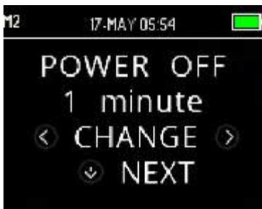
Установите режим выключения питания, чтобы определить, через какое время устройство автоматически выключится.
