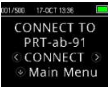
Следуя инструкциям, убедитесь, что принтер включен и готов к приему данных и печати. Для входа в экран подключения прибора в главном меню OtoRead™ нажмите клавишу **UP**. Для соединения нажмите клавишу-стрелку **LEFT** или **RIGHT**.
