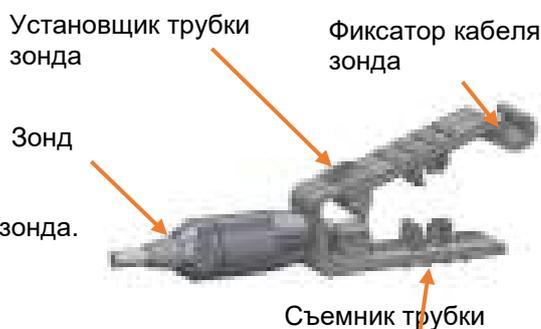
**ПРИМЕЧАНИЕ:** если трубка застрянет в инструменте, широко откройте его и выньте или вытолкните трубку из инструмента, утилизируйте трубку.
