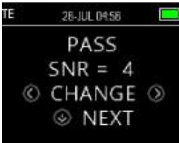
Чтобы обеспечить определение PASS / REFER для каждого теста, необходимо установить PASS SNR для каждой полосы теста TE. PASS SNR определяет на сколько децибел сигнал TEOAE должен превосходить шум, чтобы считаться присутствующим (обнаруженным) в каждой частотной полосе. PASS SNR можно установить в диапазоне 3 - 10 дБ.
