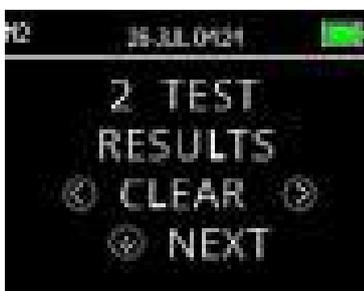
Меню «Test Results Clear» (Очистка результатов теста) позволяет пользователю очистить результаты теста, сохраненные в устройстве, без их распечатки. Чтобы очистить результаты, нажмите клавиши **< LEFT** или **RIGHT >**, а чтобы подтвердить очистку или отменить ее, - нажмите клавиши **< Yes** или **No >** соответственно. Чтобы перейти к следующему меню без очистки результатов, нажмите клавишу **∨ NEXT**.
