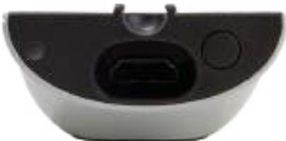
Выключите OtoRead™ и вставьте штекер микрозонда в гнездо в верхней части OtoRead™. Штекер может быть вставлен в гнездо только в одном положении.
