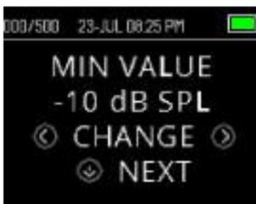
Когда значение MIN VALUE установлено, тестовая полоса (TE) или тестовая частота (DP) не считается обнаруженной, если абсолютная амплитуда в каждой полосе или на частоте равна или превышает минимальное значение, разрешенное на приборе. Это дополнительный критерий прохождения скрининга, помимо других критериев, таких как SNR.
