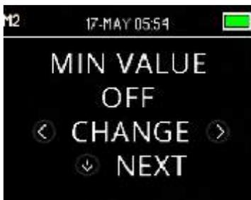
Установка минимального (амплитудного) значения позволяет пользователю настроить прибор таким образом, чтобы включить минимальное значение амплитуды в критерий pass/refer (ПРОШЕЛ/НЕ ПРОШЕЛ). В заводских установках OtoRead™ эта функция активирована.
