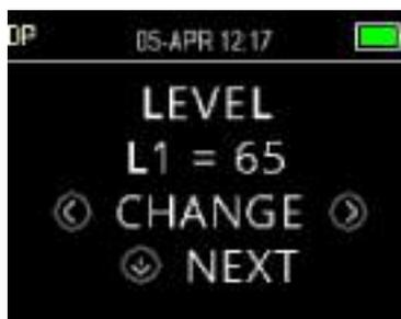
L1 – это уровень стимула основного тона f1 (частота 1). L2 – это уровень стимула основного тона f2 (частота 2). Уровень интенсивности основных тонов (L1, L2) могут изменяться в пределах от 40 дБ УЗД до 70 дБ УЗД. Уровни стимулов L1 и L2 могут увеличиваться с шагом 1 дБ нажатием клавиш **CHANGE**.
