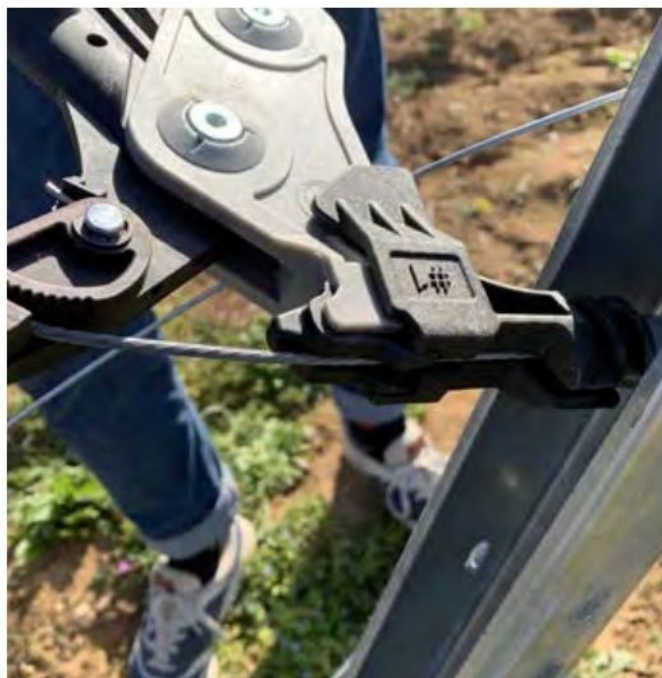
Adaptor – in cazul in care intinzatorul este instalat in interiorul spalierului
