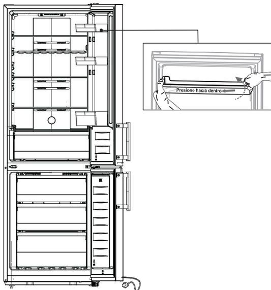
2. Quite la parte ①, luego quite la parte ② desde la parte superior derecha del refrigerador. Desatornille los tornillos ③ utilizando un destornillador de 8 mm o una llave y quite la bisagra ④. Sostenga la puerta superior con la mano mientras la instala. Utilice una espátula o un destornillador de punta plana para hacer palanca en la parte ⑤ que se encuentra en el rincón izquierdo superior del refrigerador.
