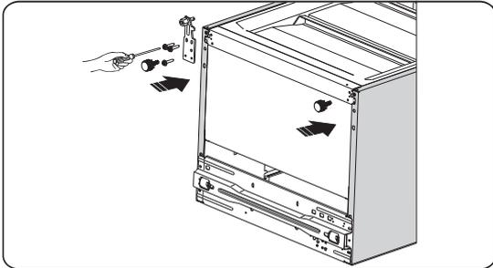
12. Cambie la puerta inferior a la posición de propiedad, ajuste la pieza de bisagra inferior colocando el eje de bisagra en el orificio inferior de la puerta inferior y, a continuación, apriete los tornillos.
