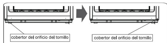
11. Vuelva a colocar la parte de la bisagra inferior en el lado izquierdo y fíjela con los tornillos especiales. Vuelva a colocar las patas inferiores regulables en el otro lado y sujételas parcialmente.
