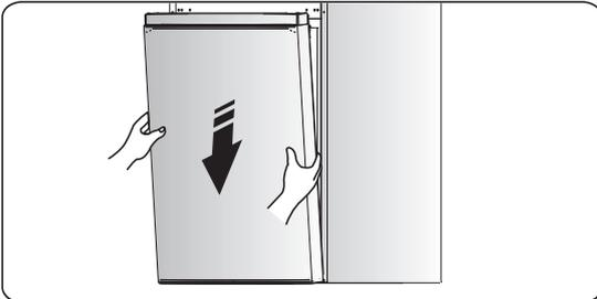
13. Posicione la puerta inferior en la clavija de la bisagra inferior y manténgala en posición. Gire la bisagra central a 180°, cambie la arandela del eje al lado inferior, sujete la bisagra central en la posición correcta y luego instálela y asegúrese que la puerta esté firme en el lugar.
