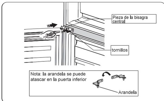
14. Cambie la puerta superior a la posición adecuada. Asegure el nivel de la puerta y coloque el eje de la bisagra central en el orificio inferior de la puerta superior.
