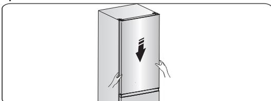
15. Mueva la puerta superior a la posición correcta y fije la parte ④ utilizando los tornillos ③. (Sostenga la puerta con la mano mientras la instala.) Instale el cobertor de la bisagra superior ② en el rincón derecho utilizando el tornillo ①. Instale el cobertor del orificio del tornillo ⑤ en el rincón superior derecho del refrigerador.
