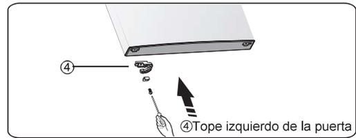
7. Cambie el tornillo y el cobertor del orificio del tornillo en la placa central del lado izquierdo al derecho (como se muestra en la siguiente imagen).
