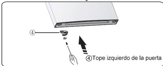
5. Desatornille los dos tornillos autorroscantes de la brida especial que se usan para fijar la pieza de la bisagra central y, a continuación, retire la pieza de la bisagra central que sujeta la puerta inferior.
