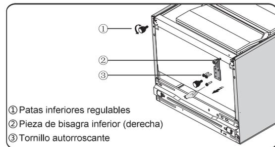
9. Retire la pieza ① de la pieza de bisagra inferior (derecha), afloje el perno de la bisagra inferior, cámbiela al lado del orificio contrario y, a continuación, apriétela en la posición e instale la pieza ① en el perno de la bisagra inferior.
