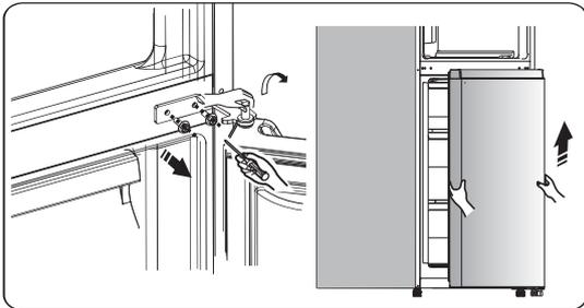
6. Coloque la puerta inferior sobre una superficie suave con los paneles hacia arriba. Afloje el tornillo ③ y quite la parte ① y la parte ②. Luego, instale el tope izquierdo de la puerta ④ (proporcionado dentro de la bolsa de plástico) y la parte izquierda ② y el tornillo ③ en el lado izquierdo y ajústelos firmemente. Mantenga la pieza ① con el aparato para consultas futuras.
