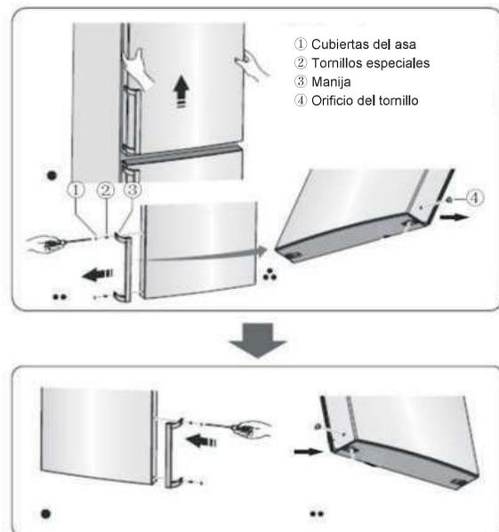
**¡Advertencia!** Al cambiar el lado desde el que se abre la puerta, el aparato no debe estar conectado a la corriente. Retire el enchufe de la corriente de antemano.
