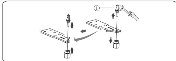
10. Cambie los cobertores del orificio del tornillo de la placa inferior de izquierda a derecha (como se muestra en la siguiente imagen).
