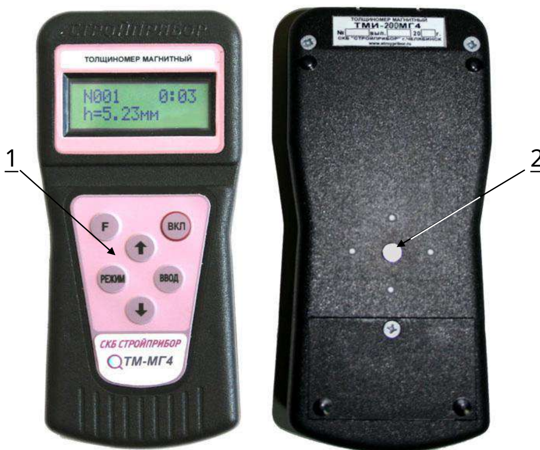
Figura 1.1 – Vedere generală a calibrei de grosime
