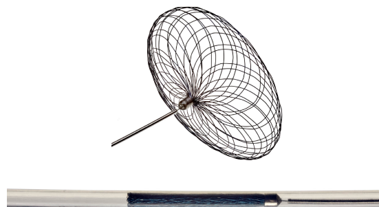
Figura 2. Extremidade distal do dispositivo (não constricto e constricto no introdutor).
