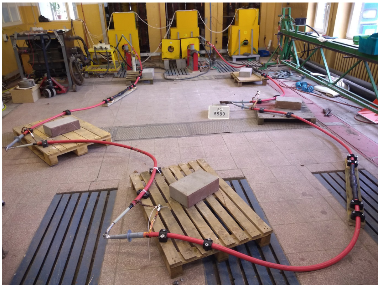
Rysunek 5. Widok obiektu badań po próbie wytrzymałości zwarciowej żyły powrotnej Nr 5580/2019.05.08
