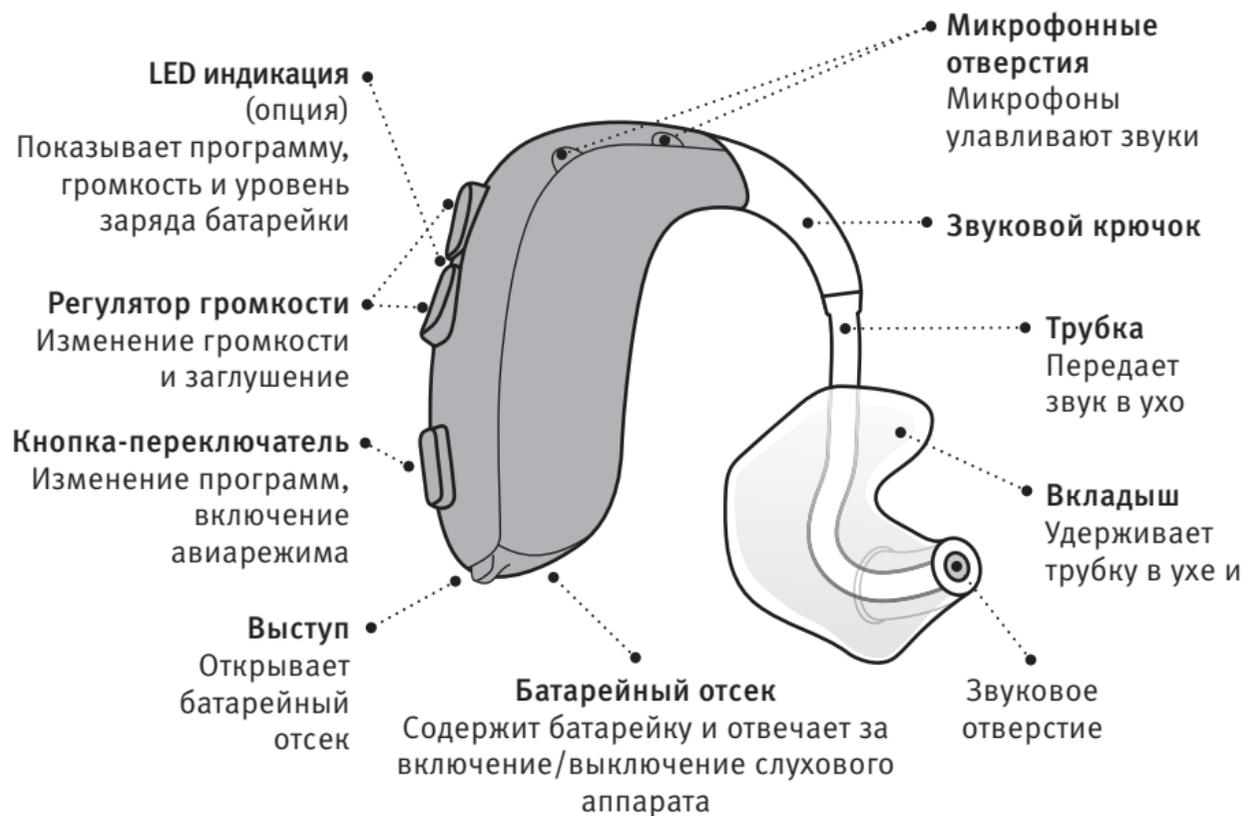
Модели BTE SP и BTE UP имеют одинаковое управление. В данной инструкции изображена модель BTE SP.
