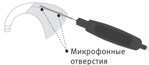
Удаляйте загрязнения только с внешней поверхности корпуса, стараясь не залезать ворсинками щеточки в сами отверстия. В противном случае, слуховой аппарат может быть поврежден.
