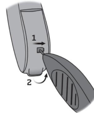
Вставьте кончик инструмента в отверстие с обратной стороны батарейного отсека.
