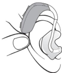
Осторожно потяните ухо наружу и вставьте ушной вкладыш, прижимая и слегка проворачивая его, по направлению ушного канала.
