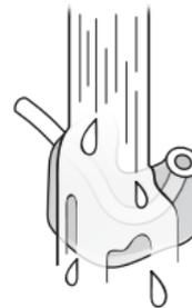
Промойте вкладыш и трубочку водой с мягким мылом. Прополосните и полностью высушите его перед соединением со слуховым аппаратом.
