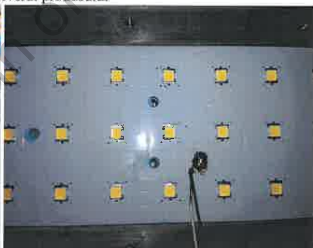
Amplasarea termocuplului pe Sbs. Modul LED
