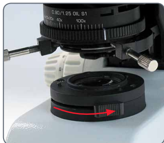
Полевая диафрагма по Келеру закрыта
