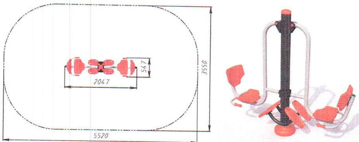
Componente: pilon de sprijin, bază inferioară, sistem de pârghii, 2 scaune, suporturi pentru picioare.
