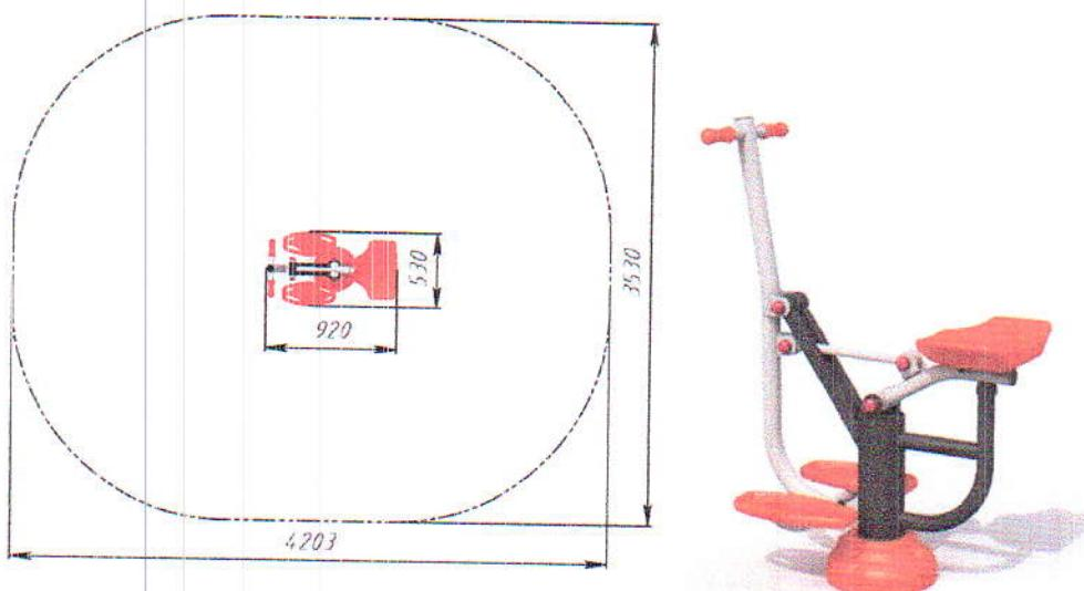
Componente: bază inferioară, sistem de pârghii, mânere, scaun, suport pentru picioare.
