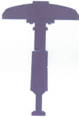
Fig. 6 – Suprafața de referință (*) pentru modelul 3D al corpului de iluminat aflat în poziția de încercare longitudinal orizontal ( \alpha_{xz} = 0^\circ și \beta_{xy} = 0^\circ )
