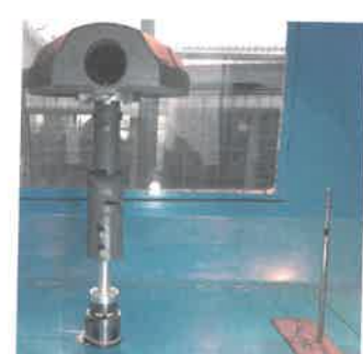
Fig. 11 – Corpul de iluminat montat în camera de experimentare a tunelului aerodinamic în poziția de încercare lateral orizontal ( \alpha_{xz} = 0^\circ ; \beta_{xy} = 90^\circ )
