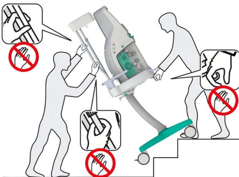
Imaginea 4-6 A nu se utiliza stativul de perfuzii sau cârligele de cântărire pentru deplasarea sau transportarea aparatului.
