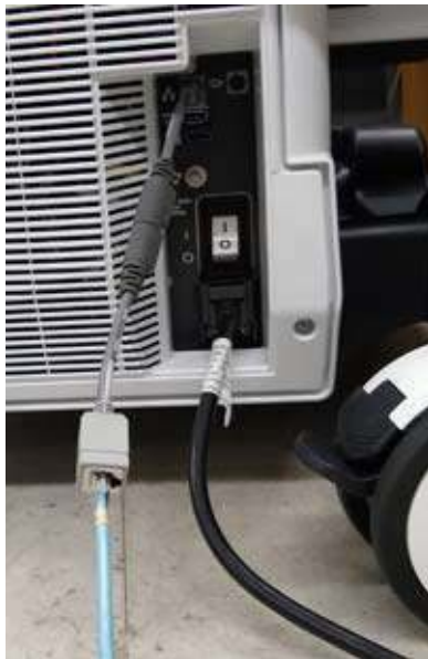
Figura 3-7. Cablu LAN cu protecție (exemplu)
