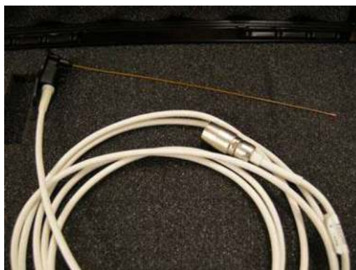
Figura 12-151. Vedere apropiată a senzorului vârfului acului și a cablului
