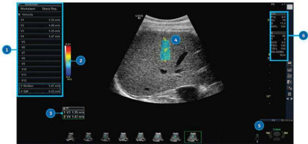
Figura 12-56. Afișarea undei de forfecare cu măsurătoare
